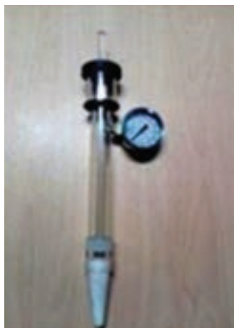
تانسیومتر آنالوگ مدل آب ۳۰ سانتی‌متری
