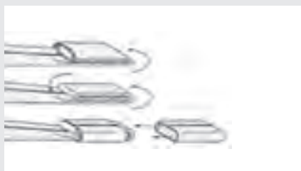
شکل ۱۳- مسدود کردن انتهای نوار
